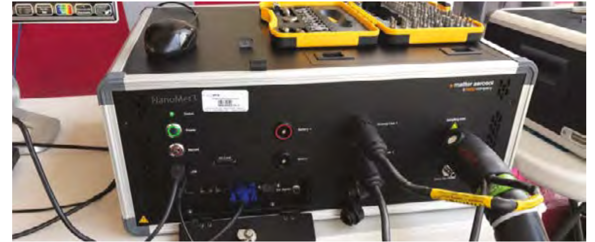
Equipo para la medición del número de nanopartículas con la que se realizan pruebas de desempeño en el Verificentro del Sistema de Aguas de la Ciudad de México, 7 de agosto de 2017.
