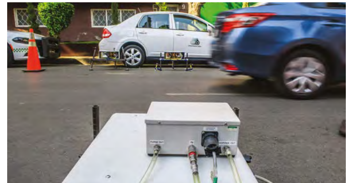
Equipo sensor remoto que utiliza el personal de la SEDEMA para realizar las campañas de detección de vehículos ostensiblemente contaminantes.
