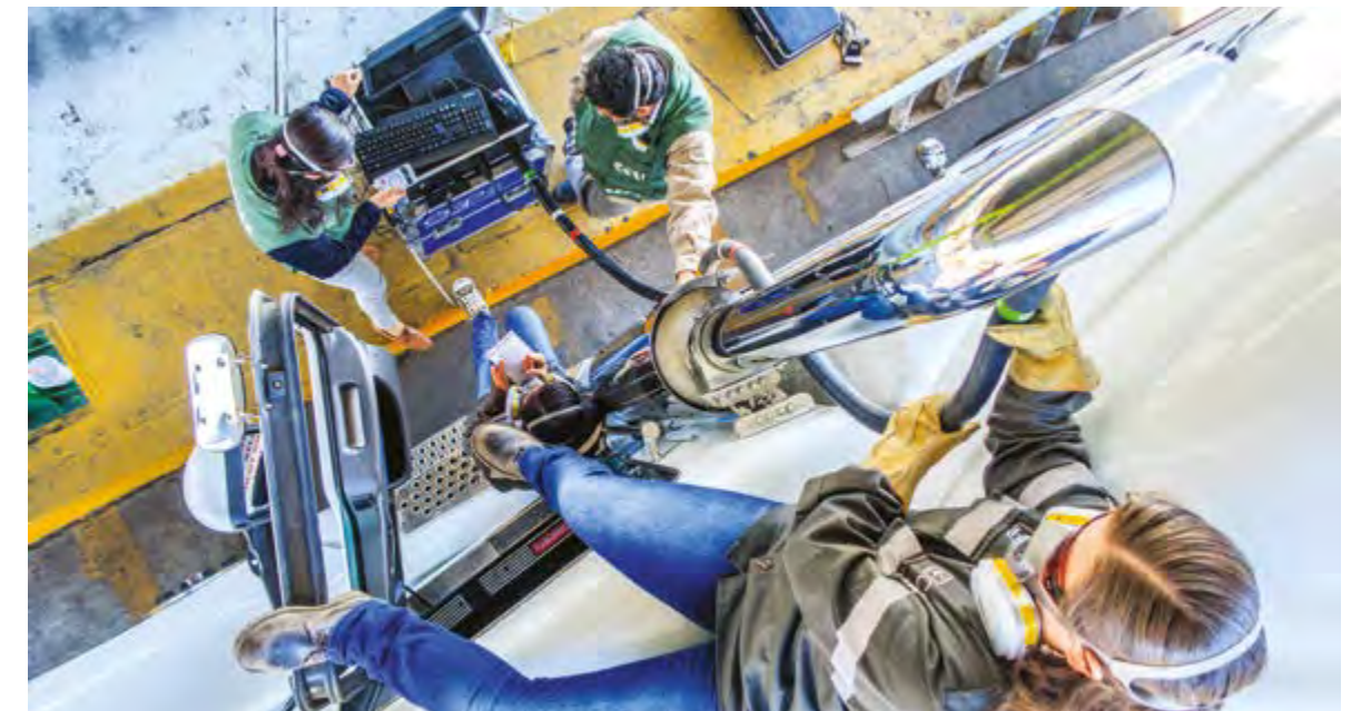
Pruebas de emisiones de partículas ultrafinas por personal de la SEDEMA en vehículos de carga, 21, 23 y 24 de enero 2017.
