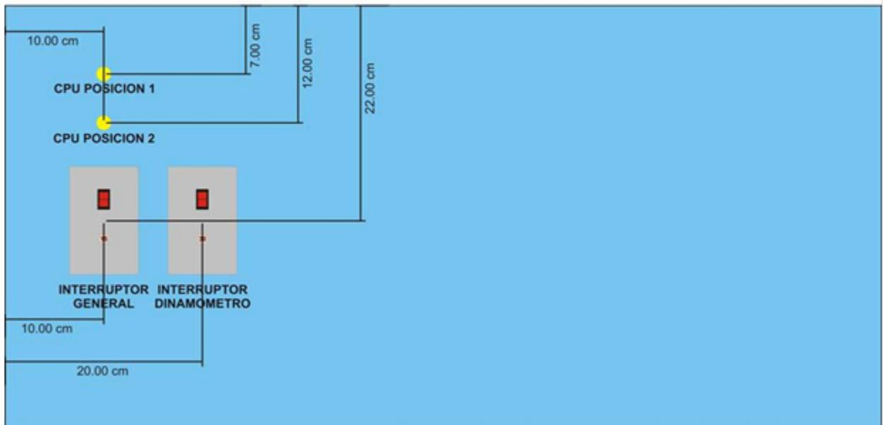
Figura 17. Detalle de la ubicación de los interruptores generales
