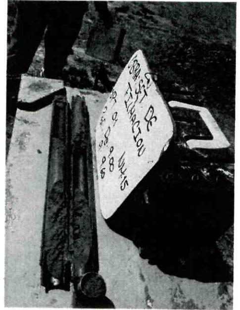
EN EL LABORATORIO SE CLASIFICARÁN EN FORMA VISUAL Y AL TACTO EN ESTADO HÚMEDO Y SECO MEDIANTE PRUEBAS DEL SISTEMA UNIFICADO DE CLASIFICACIÓN DE SUELOS (SUCS).
