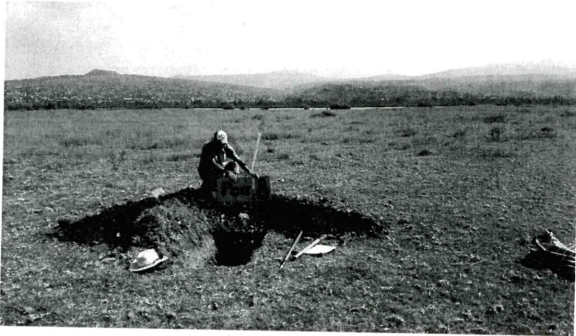
EXCAVACIÓN SUPERFICIAL POR MEDIO DEL POZO A CIELO ABIERTO PCA-8, EL RELLENO SE ENCONTRÓ HASTA UNA PROFUNDIDAD DE 2.10 m. COMPUESTO POR BASURA POR BASURA Y ARCILLA ARENOSA CAFÉ.
