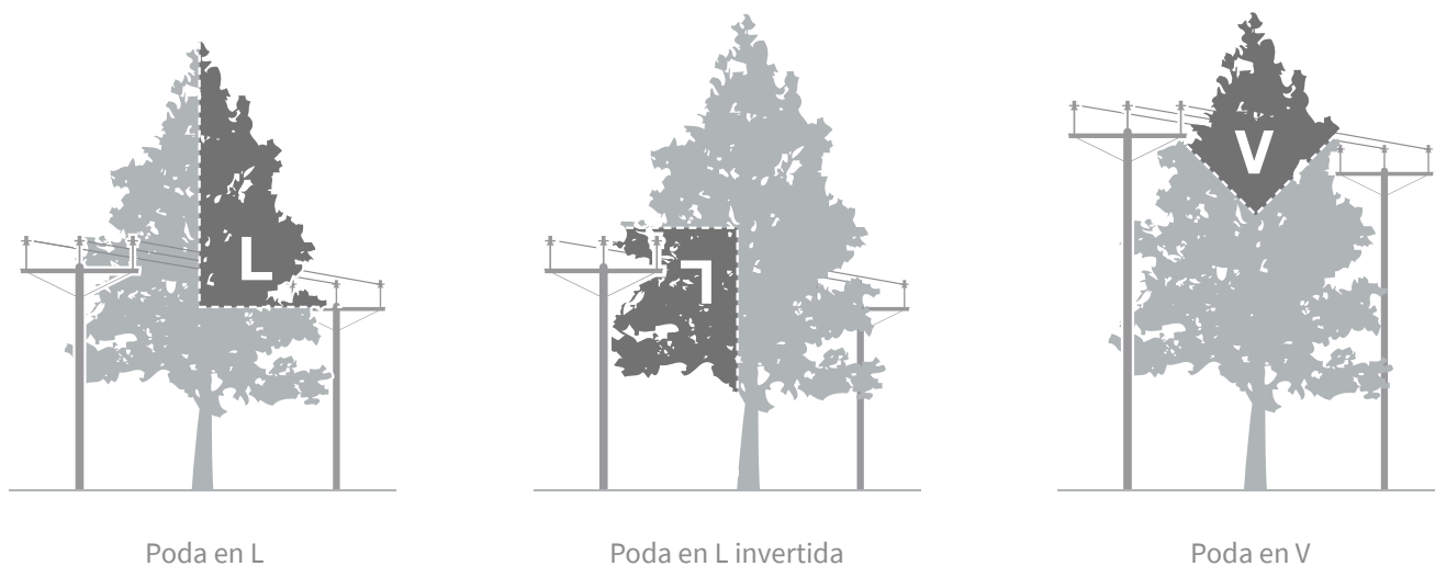
Figura 3.24 Poda de árboles bajo cables energizados.
