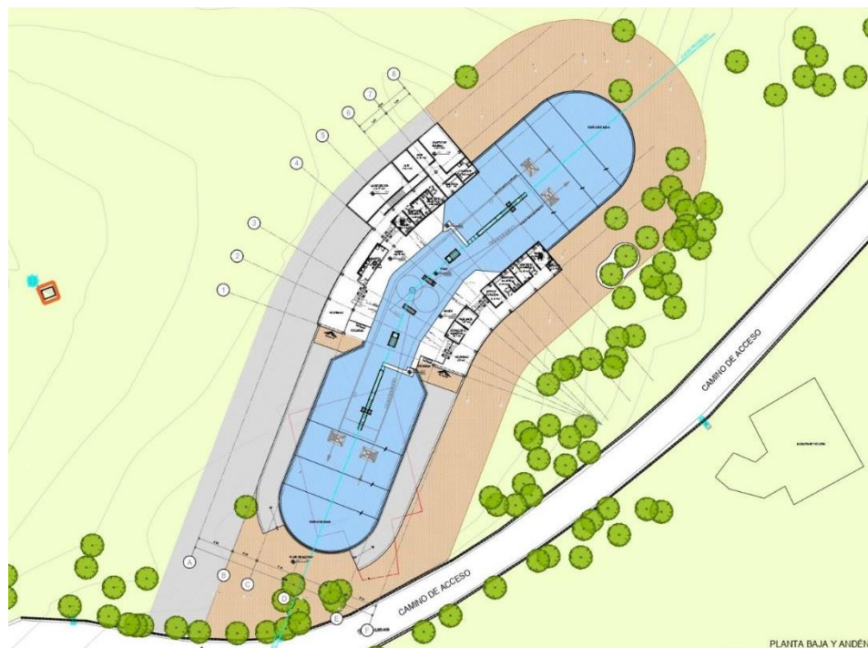
Imagen II- 20. Planta arquitectónica estación 2 Cineteca Nacional
