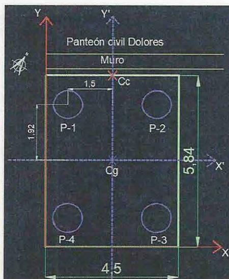
Esquema 4.1. Planta de pilas y referencia de ejes generales y centroidales. Cc: centro de cargas; Cg: centro de pilas
