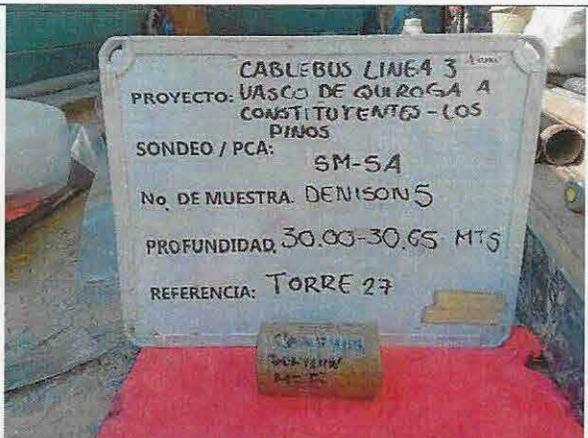
**Foto No. 1.11** Detalle de muestra obtenida a la profundidad de 30.00 a 30.65 m en el sondeo 5A.
