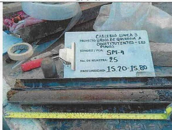
**Foto No. 1.3 Detalle de muestra alterada obtenida a la profundidad de 15.20 a 15.80 m en el sondeo SPT-4.**
