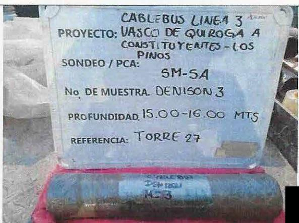
**Foto No. 1.10** Detalle de muestra obtenida a la profundidad de 15.00 a 16.00 m en el sondeo 5A.
