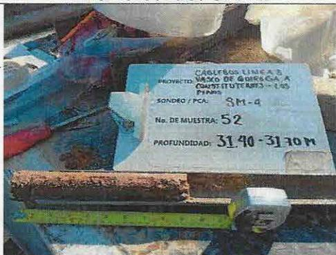
**Foto No. 1.5 Detalle de muestra alterada obtenida a la profundidad de 31.40 a 31.70 m en el sondeo SPT-4.**
