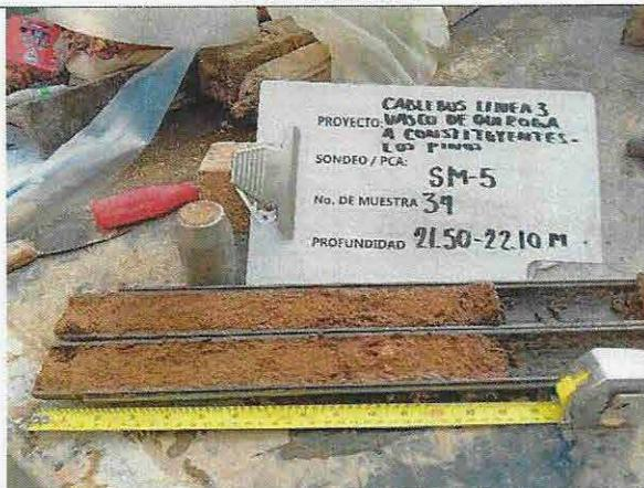
Foto No. 1.5 Detalle de muestra alterada obtenida a la profundidad de 21.50 a 22.10 m en el sondeo 5.
