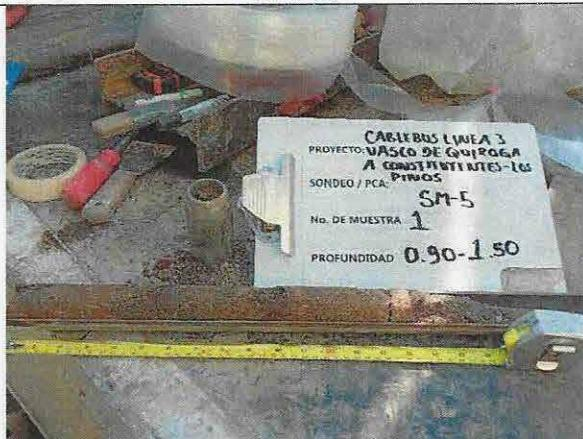
Foto No. 1.3 Detalle de muestra alterada obtenida a la profundidad de 0.90 a 1.50 m en el sondeo 5.
