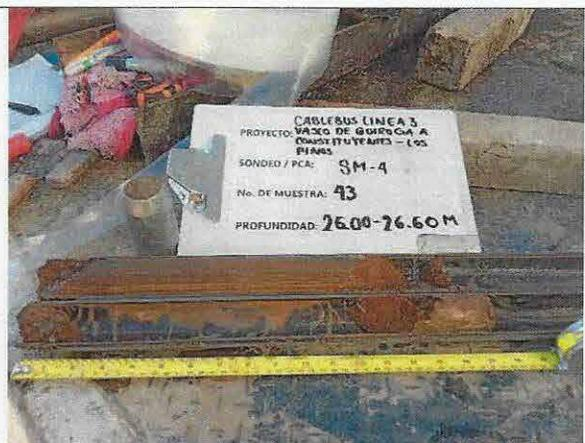
**Foto No. 1.4 Detalle de muestra alterada obtenida a la profundidad de 26.00 a 26.60 m en el sondeo SPT-4.**
