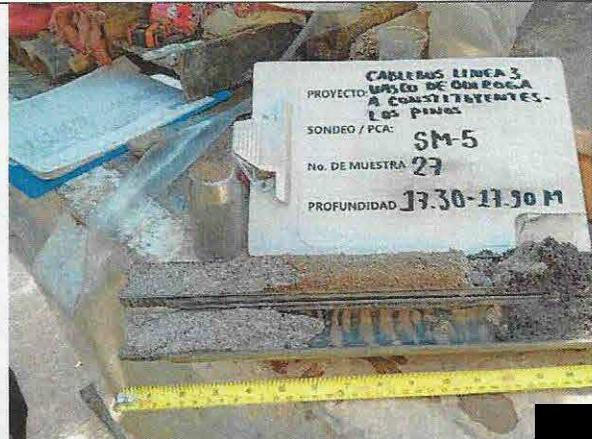
Foto No. 1.4 Detalle de muestra alterada obtenida a la profundidad de 17.30 a 17.9 m en el sondeo 5.
