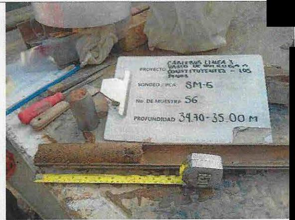
Foto No. 1.6 Detalle de muestra alterada obtenida a la profundidad de 34.70 a 35.00 m en el sondeo 5.
