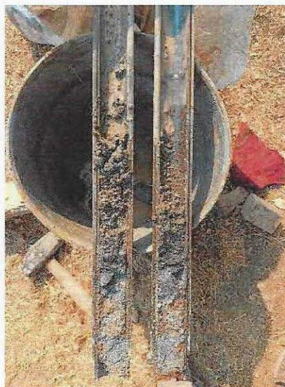
Fotografías 3 y 4. Muestras alteradas recuperadas en sondeo SPT-1, T-30
