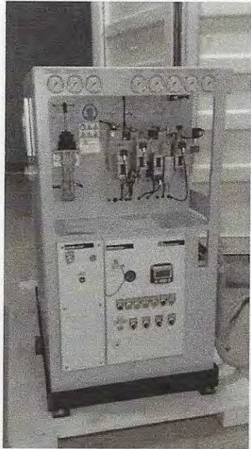
Modelo real de una unidad hidráulica de frenos y accionamiento de emergencia, frenos mecánicos de servicio y frenos mecánicos de emergencia
