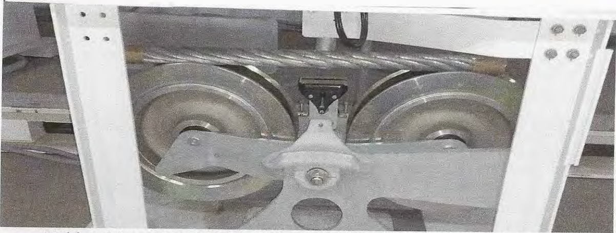
Modelo real de un sistema de poleas en torre, RPD (detección de posición de cable) e interruptor de horquilla
