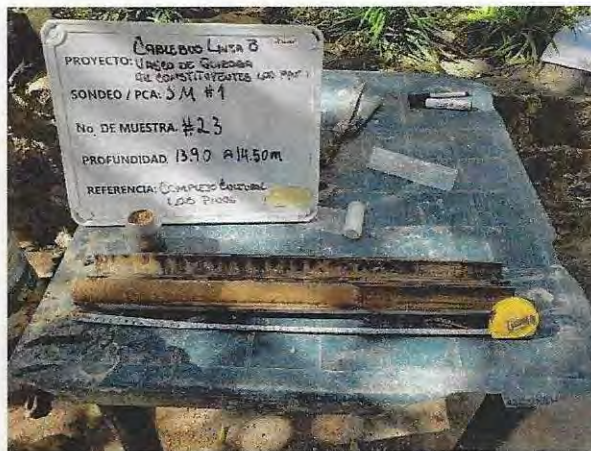
Fotografía 4. Detalle de muestra alterada obtenida a la profundidad de 13.90 a 14.50 m en el sondeo 1.
