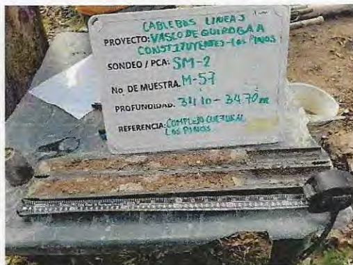
Fotografía 11. Detalle de muestra alterada obtenida a la profundidad de 34.10 a 34.70 m en el sondeo SPT-2.
