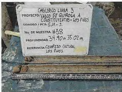
Fotografía 5. Detalle de muestra alterada obtenida a la profundidad de 34.90 a 35.02 m en el sondeo 1.
