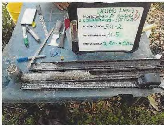
Fotografía 9. Detalle de muestra alterada obtenida a la profundidad de 2.90 a 3.50 m en el sondeo SPT-2.
