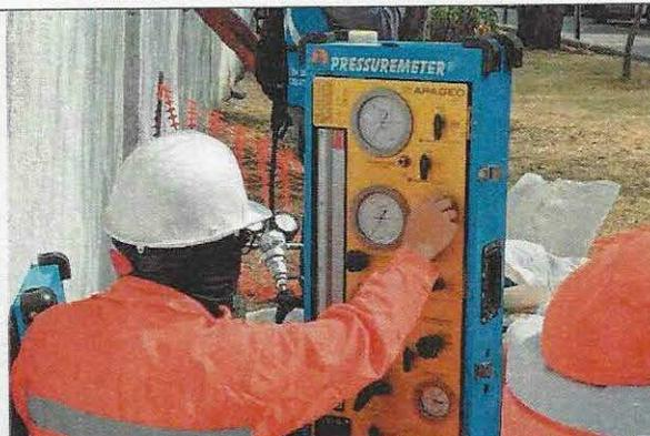
**Foto No. 1.10 Ejecución de prueba de Presiómetro dentro del sondeo SAC-13A**
