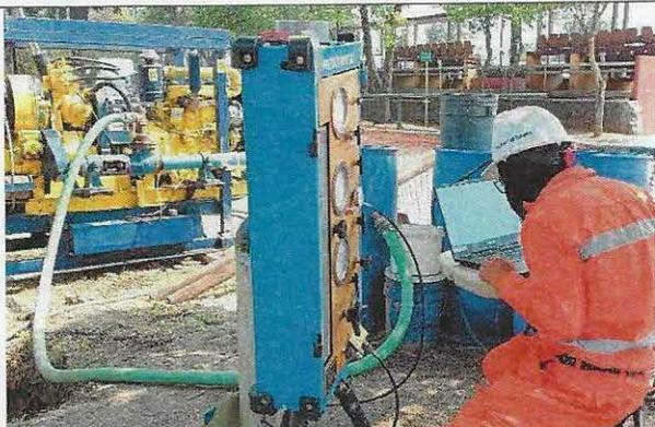
**Foto No. 1.9 Ejecución de prueba de Presiómetro dentro del sondeo SAC-13A**
