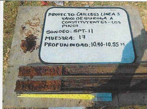
Foto No. 1.4 Detalle de muestra alterada obtenida a la profundidad de 10.40 a 10.55 m en el sondeo SPT-11.
