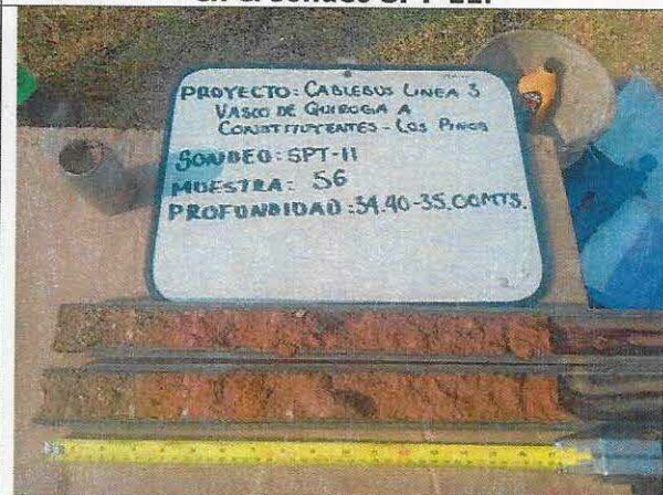
Foto No. 1.6 Detalle de muestra alterada obtenida a la profundidad de 34.40 a 35.00 m en el sondeo SPT-11.
