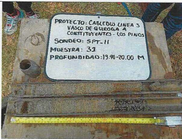
Foto No. 1.5 Detalle de muestra alterada obtenida a la profundidad de 19.40 a 20.00 m en el sondeo SPT-11.
