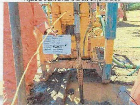
Figura 4. Sonda del phicómetro después de la prueba.
