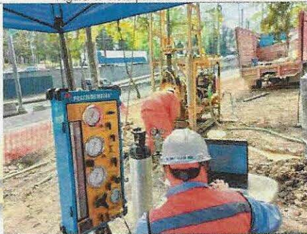
Figura 3. Ejecución de prueba de phicómetro.
