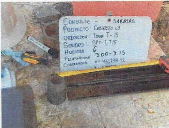
Fotografía 9. Muestra alterada 6 recuperada con el penetrómetro estándar.
