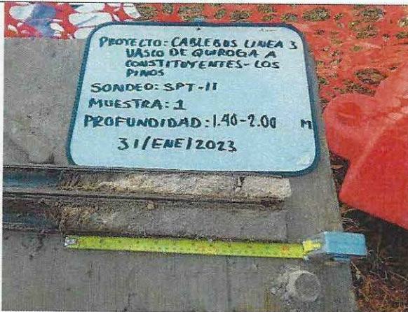
Foto No. 1.3 Detalle de muestra alterada obtenida a la profundidad de 1.40 a 2.00 m en el sondeo SPT-11.
