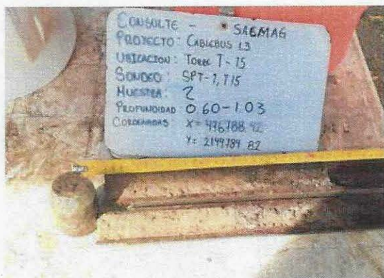
Fotografía 5. Muestra alterada 2 recuperada con el penetrómetro estándar.
