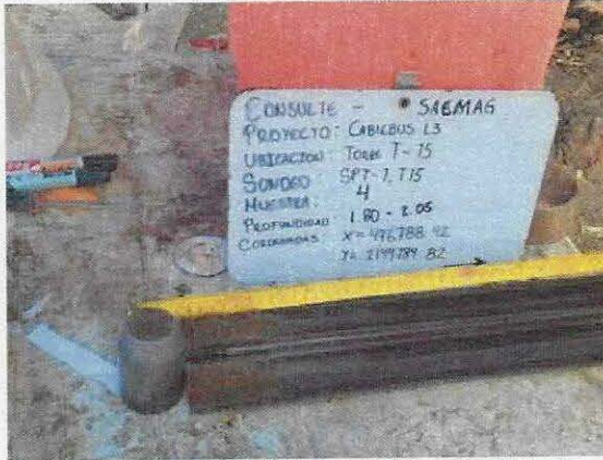
Fotografía 7. Muestra alterada 4 recuperada con el penetrómetro estándar.
