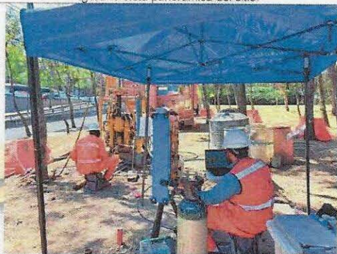
Figura 3. Ejecución de prueba de phicómetro.
