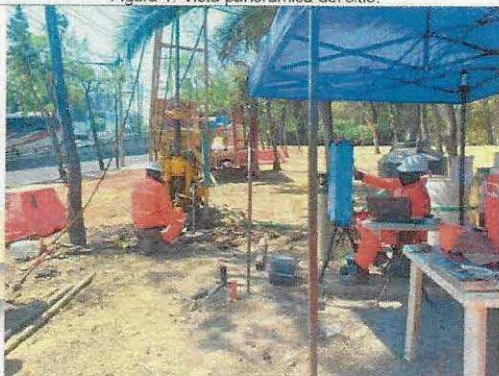
Figura 3. Ejecución de prueba de phicómetro.
