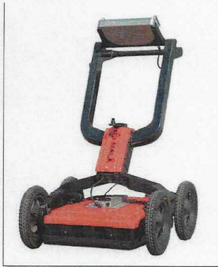
Foto No. 3.1 Equipo de Exploración GPR
