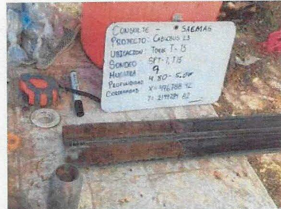
Fotografía 10. Muestra alterada 9 recuperada con el penetrómetro estándar.
