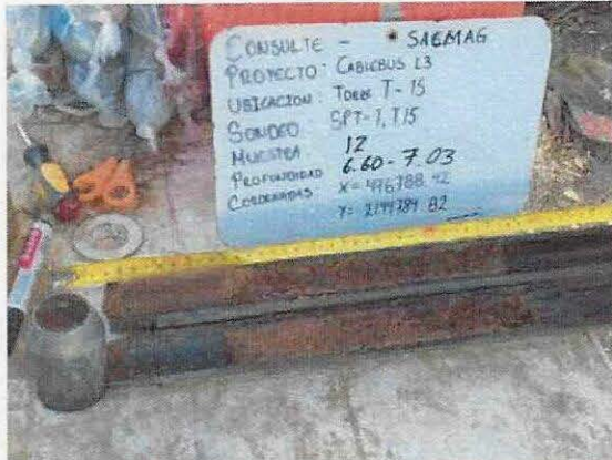
Fotografía 13. Muestra alterada 12 recuperada con el penetrómetro estándar.
