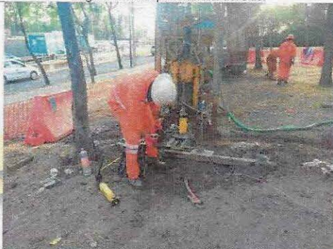
Figura 3. Ejecución de prueba de phicómetro.
