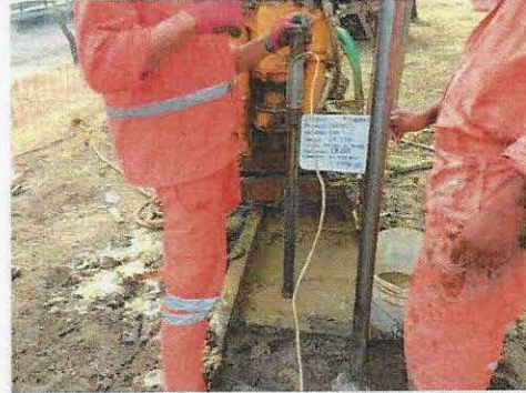
Figura 2. Inserción de la sonda del phicómetro.
