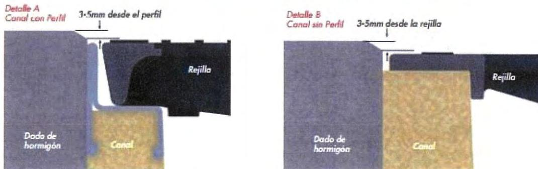
Figura 10. Detalle A y B para tipo de canal
