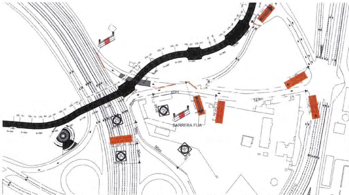
Figura 8.12. Vista en planta particular de área bloqueada por trabajos de columnas P 17 y 18 en carril para la incorporación a la lateral de Av. Periférico sentido norte.
