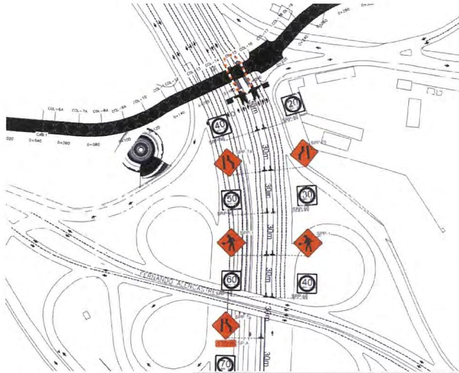
Figura 8.2. Vista en planta particular de área bloqueada por trabajos de columnas P-16 en la lateral de Av Periférico sentido Norte
