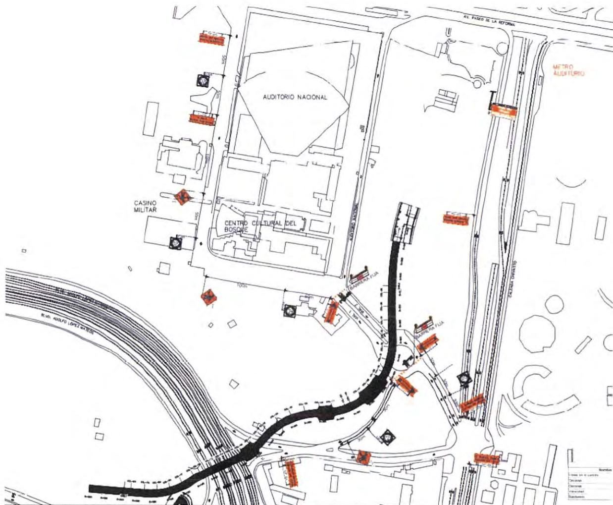
Figura 8.13. Planta general de señalización de obra para trabajos de columnas P-31, 32 y 33 en vía de la glorieta de Chivatito frente al Estacionamiento Ecológico.
