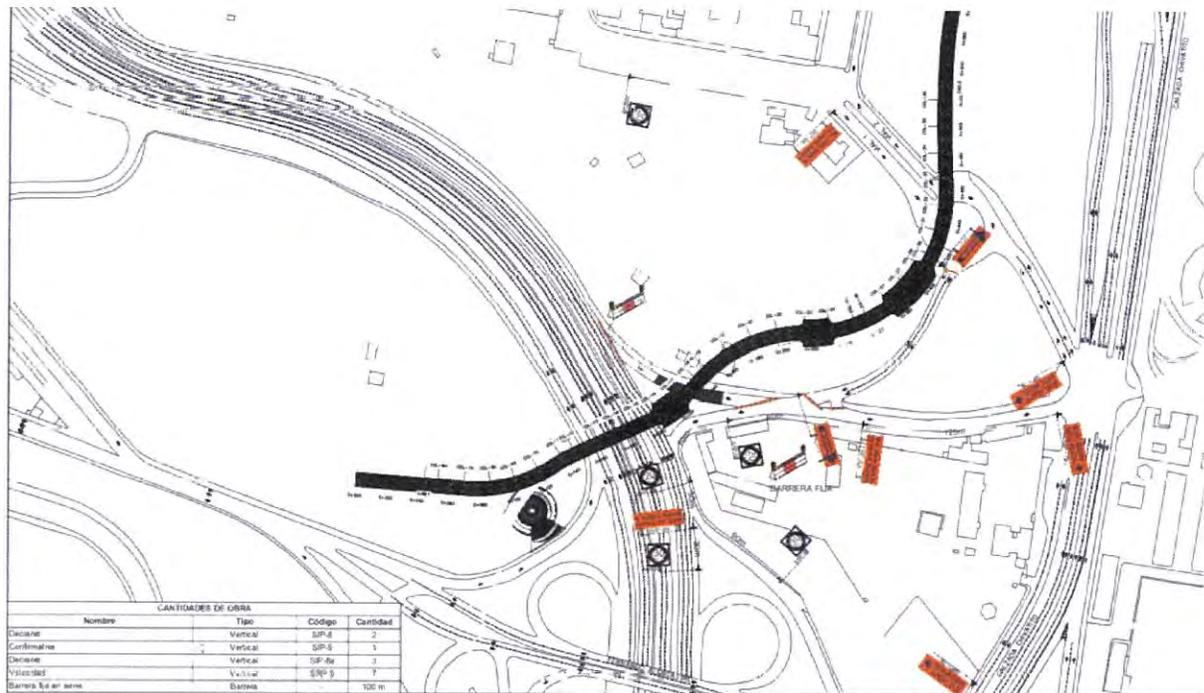
Figura 8.11. Planta general de señalización de obra para trabajos de columnas P-17 y 18 en carril para la incorporación a la lateral de Av. Periférico sentido norte.
