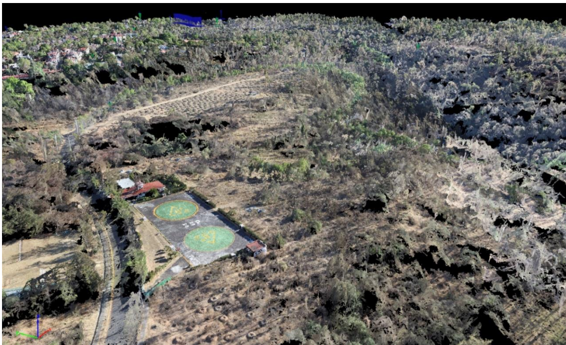
Figura 1.28 Identificación de control Terrestre con GNSS en el proceso de aerotriangulación para nube de puntos densificada.
