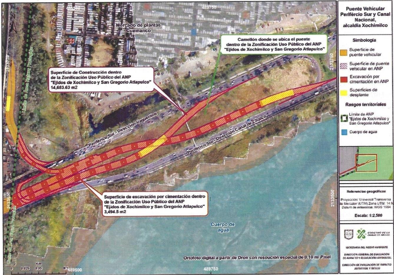
Mapa 1. Superficies de construcción y excavación para cimentación del Proyecto a desarrollarse dentro del camellón.
