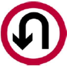
**VUELTA EN «U»:** Indica a los conductores de vehículos que el movimiento de vuelta en «U» se debe realizar a través del carril de desaceleración del costado derecho o izquierdo
