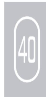
**INDICACIÓN DE VELOCIDAD EN EL CARRIL:** Indica a los conductores de vehículos el límite de velocidad permitido, en kilómetros por hora, expresado en múltiplos de 10.
