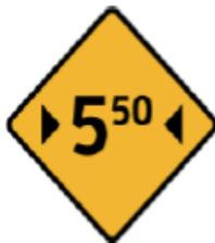
**ANCHO LIMITADO:** Indica a los conductores de vehículos la proximidad de un ancho libre que puede verse limitado por una estructura angosta o por las condiciones físicas del entorno de la vía, las cuales pueden afectar a ciertos vehículos.
