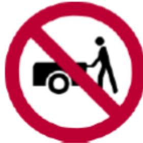
PROHIBIDO EL TRÁNSITO DE VEHÍCULOS DE TRACCIÓN HUMANA: Indica a los conductores de vehículos de tracción humana utilizados para el transporte de carga a mano, que se prohíbe su tránsito en ciertos carriles o en un determinado tramo de la vía, por representar un riesgo o entorpecer el desplazamiento de los demás vehículos.
