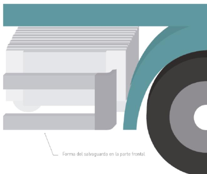
Si en la parte delantera del salvaguarda la distancia con la cabina del vehículo excede los 0.35 m, este espacio debe ser cubierto con una barra o panel adicional con características de resistencia similares al del dispositivo (figura 4).
