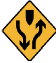
**SEPARADOR O ISLA:** Indica a los conductores de vehículos la proximidad del inicio o final de una faja separadora central, isla u obstáculo fijo o temporal, el cual divide una vía en uno o dos sentidos de circulación.
