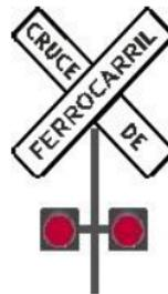
**SEMÁFORO PARA CRUCES CON VÍAS FÉRREAS:** Previene a los conductores de vehículos de la aproximación de un cruce a nivel con una vía férrea.
