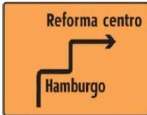
**DIAGRAMÁTICA DE DESVÍO:** Indica a los conductores de vehículos, mediante un esquema, los puntos de decisión en los que se debe realizar una maniobra para librar un zona de obra y poder regresar a la ruta principal.
