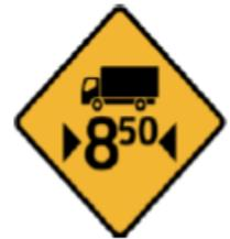
**LONGITUD LIMITADA:** Indica a los conductores la proximidad de una vía donde existen curvas horizontales o verticales pronunciadas, en las que no es posible el tránsito de vehículos que excedan la dimensión indicada en la señal.
