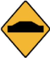
**REDUCTOR DE VELOCIDAD:** Indica a los conductores de vehículos la proximidad de un reductor de velocidad sobre la superficie de rodadura. El pictograma representa el tipo de reductor presente en la vía: lomo, cojín, vibrador o depresión.
