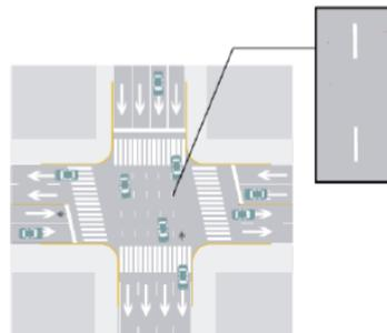
**RAYA GUÍA EN INTERSECCIÓN:** Indica a los conductores de vehículos la trayectoria que deben seguir, en intersecciones que, por su diseño o condiciones de visibilidad, no son predecibles.
