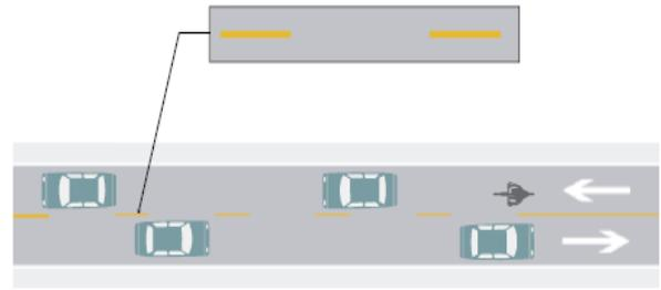
**RAYA SEPARADORA DE SENTIDOS DE CIRCULACIÓN DISCONTINUA SENCILLA:** Indica a los usuarios la separación de los sentidos de circulación vehicular, en vías en las que se permite el rebase utilizando el carril en sentido contrario.
