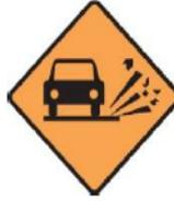
**MATERIAL SUELTO:** Indica a los conductores de vehículos la proximidad de un tramo en el cual el pavimento presenta gravilla suelta que puede ser proyectada por el paso de vehículos o material fino que impida el control del vehículo al frenar.
