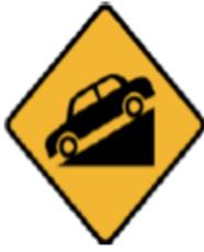
**PENDIENTE PRONUCNIADA:** Indica a los conductores de vehículos la proximidad de una pendiente descendente en la cual se requiere frenar constantemente, de preferencia con motor. En casos especiales, se puede usar este símbolo invertido para indicar una pendiente ascendente.
