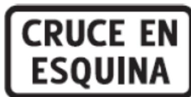
**CONDICIÓN ESPECÍFICA:** Indica a los usuarios la característica particular de la restricción, o, mediante un pictograma, el tipo de vehículo que está obligado a realizar la acción o movimiento indicado en la señal. Algunas leyendas que se pueden usar son:
