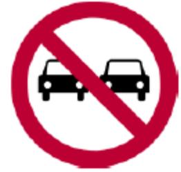
**PROHIBIDO REBASAR:** Indica a los conductores de vehículos los tramos en los que no se permite adelantar a otro, por condiciones especiales como visibilidad o el ancho de la vía, entre otras. El pictograma indica el tipo de vehículo al cual se restringe realizar esta acción.
