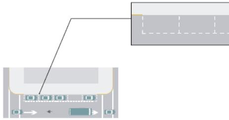
**ESTACIONAMIENTO EN ZONAS DE PARQUÍMETROS:** Indica a los usuarios la presencia de espacios para estacionamiento, en zonas con cobro en vía pública. El usuario debe hacer uso de un solo cajón para estacionar su vehículo.
