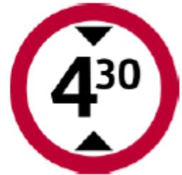
**ALTURA PERMITIDA:** Indica a los conductores de vehículos de grandes dimensiones, la altura libre de un elemento o estructura que limita su tránsito.
