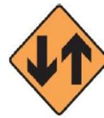
**DOBLE SENTIDO DE TRÁNSITO:** Indica a los conductores de vehículos que circulan en un tramo de un solo sentido, la proximidad de un tramo de circulación en ambos sentidos.
