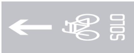
**IDENTIFICACIÓN DE VÍA CICLISTA EXCLUSIVA:** Indica a los usuarios la existencia de un ciclocarril, ciclovia unidireccional o ciclovia de trazo independiente.
