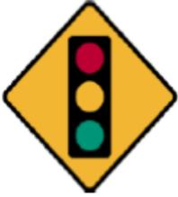
**SEMÁFORO:** Indica a los conductores de vehículos la proximidad de una intersección controlada por semáforos en una vía donde no se espera encontrarlos, o en un cruce donde no sea visible desde una distancia suficiente para reducir la velocidad y detenerse.
