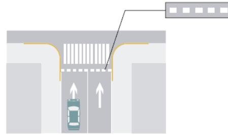
**RAYA DE CEDA EL PASO:** Indica a los conductores de vehículos el lugar en el que deben detenerse debido a una señal de ceda el paso.
