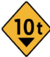
**PESO LIMITADO:** Indica a los conductores de vehículos la proximidad de una vía o puente en los cuales sólo se permite el tránsito de vehículos cuyo peso bruto total no exceda aquel indicado en la señal.
