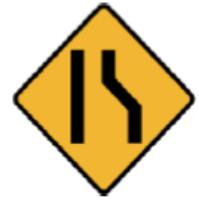
**REDUCCIÓN O AMPLIACIÓN ASIMÉTRICA:** Indica a los conductores de vehículos la proximidad de un estrechamiento o ensanchamiento de la vía, ya sea por reducción o ampliación del número de carriles, o por modificación de las dimensiones de la sección transversal en forma asimétrica.
