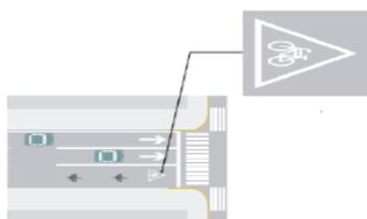
**IDENTIFICACIÓN DE VÍA CON PRIORIDAD DE USO:** Indica a los usuarios que están circulando por una vía, en la que un tipo de vehículo tiene derecho en su utilización sobre los demás.
