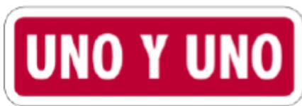
**PASO UNO POR UNO:** Indica a los conductores de vehículos que en la intersección a cruzar está regulado el tránsito en un ritmo de uno y uno; por lo tanto, deben detenerse, permitir el paso de un vehículo de la vía transversal y luego reiniciar la marcha.
