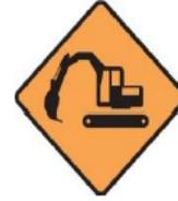
**MAQUINARIA EN LA VÍA:** Indica a los conductores de vehículos la presencia de maquinaria operando sobre la superficie de rodadura.
