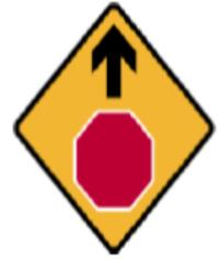
**ALTO O CEDA EL PASO:** Indica a los conductores de vehículos la proximidad de una señal SR-6 Alto o SR-7a Ceda el paso, la cual no es visible desde una distancia suficiente para reducir la velocidad y detenerse.
