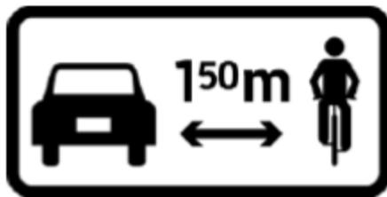
**DISTANCIA DE REBASE:** Indica a los conductores de vehículos motorizados que, al rebasar a un ciclista, deben conservar como mínimo la distancia indicada en la señal.
