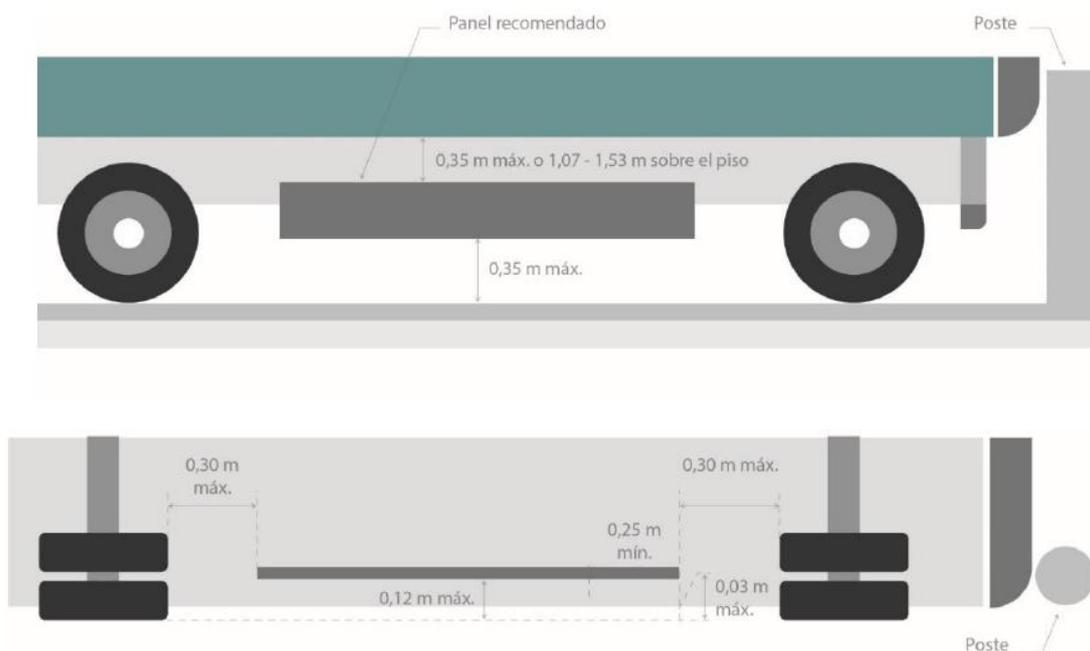
La parte inferior del salvaguarda debe estar a una altura de 0.35 m sobre la superficie de rodadura y la parte superior a 0.35 m de la plataforma del camión. Si no es posible cumplir con la cota en la parte superior del dispositivo, la parte superior de éste debe quedar entre 1.00 a 1.50 m sobre el nivel del arroyo vial.
