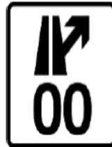
SALIDA EN SEÑAL BAJA: Indica a los conductores de vehículos el número de las desincorporaciones existentes en vías urbanas de acceso controlado.
