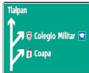
**DIAGRAMÁTICA:** Indica a los conductores de vehículos, mediante un esquema, los puntos de decisión en una intersección.
