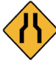
**REDUCCIÓN O AMPLIACIÓN SIMÉTRICA:** Indica a los conductores de vehículos la proximidad de un estrechamiento o ensanchamiento de la vía, ya sea por reducción o ampliación del número de carriles, o por modificación en forma simétrica de las dimensiones de la sección transversal
