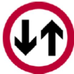
**DOBLE CIRCULACIÓN:** Indica a los conductores de vehículos el inicio de un tramo sin faja separadora central, con doble sentido de circulación, o en el cual existe tránsito en sentido inglés. Cuando la señal contenga un pictograma que represente algún tipo de vehículo, indica que éste debe circular en el sentido indicado.
