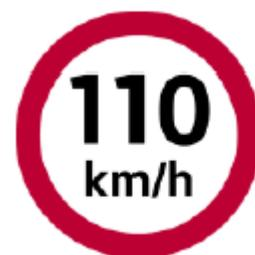
**VELOCIDAD PERMITIDA:** Indica a los conductores de vehículos el límite máximo de velocidad, expresado en múltiplos de 10 y con la leyenda «km/h».
