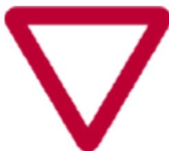
**CEDA EL PASO:** Indica a los conductores de vehículos que deben disminuir la velocidad o detenerse en las intersecciones cuando sea necesario para ceder el paso al tránsito que cruza o se incorpora a la vía.
