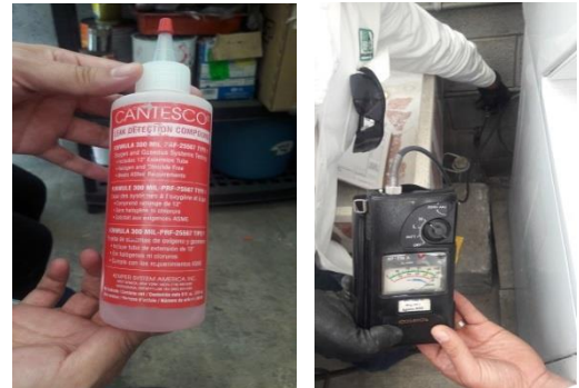
Figura 3. Equipos utilizados para detección de fugas.
